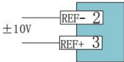
图4.3.2 外部电源模拟量输入接线
