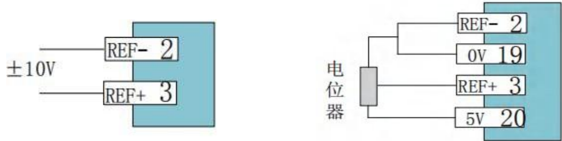
图3.2.2 外部电源模拟量输入接线
